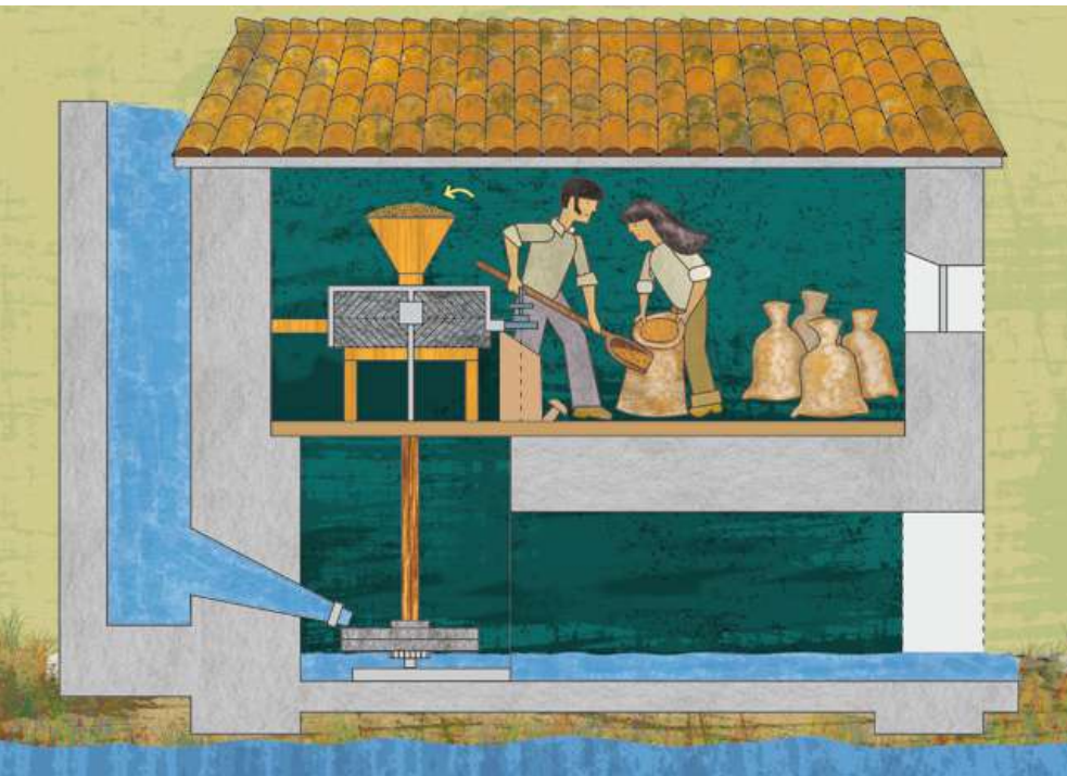
Esquema del funcionament i elements d'un molí hidràulic de rodet.
