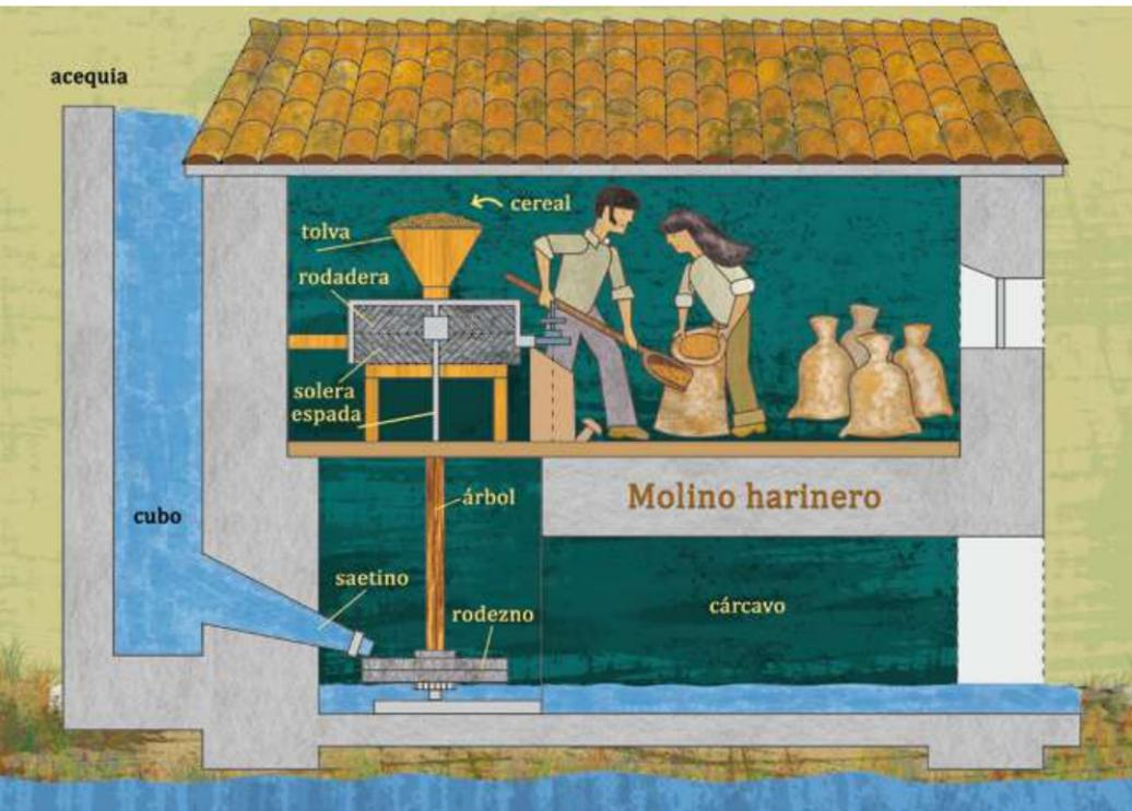
Esquema del funcionamiento y elementos de un molino hidráulico de rodezno.
