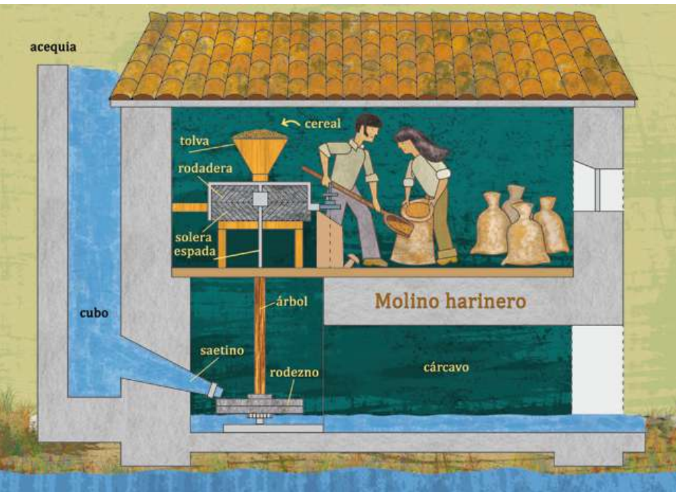
Esquema del funcionamiento y elementos de un molino hidráulico de rodezno.
